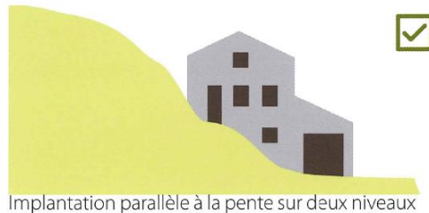
Implantation parallèle à la pente sur deux niveaux
