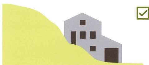
Implantation parallèle à la pente sur deux niveaux
