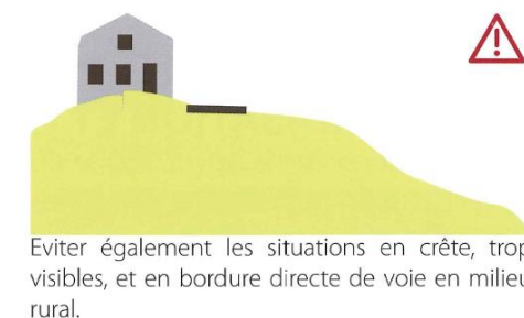
Cette configuration peut provoquer un risque de glissement de terrain, elle crée une cicatrice dans le couvert végétal et dans le paysage.
