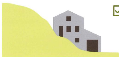
Implantation parallèle à la pente sur deux niveaux
